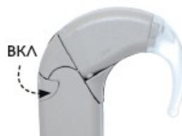
Рис. 4 Аудио процессор OPUS 2 в положении ВКЛ
