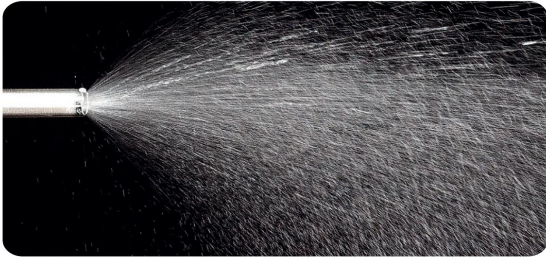
Рисунок 6 - Струя кавитированного раствора из акустического узла АА 208
